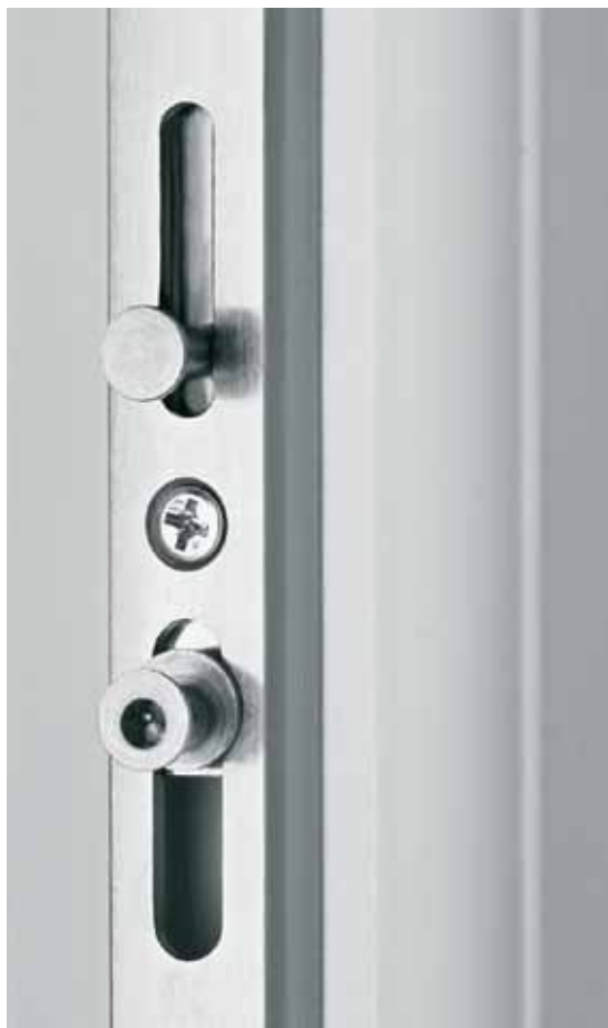
In Schließstellung greifen die Pilzköpfe zangenartig in das Sicherheitsschließblech ein.
